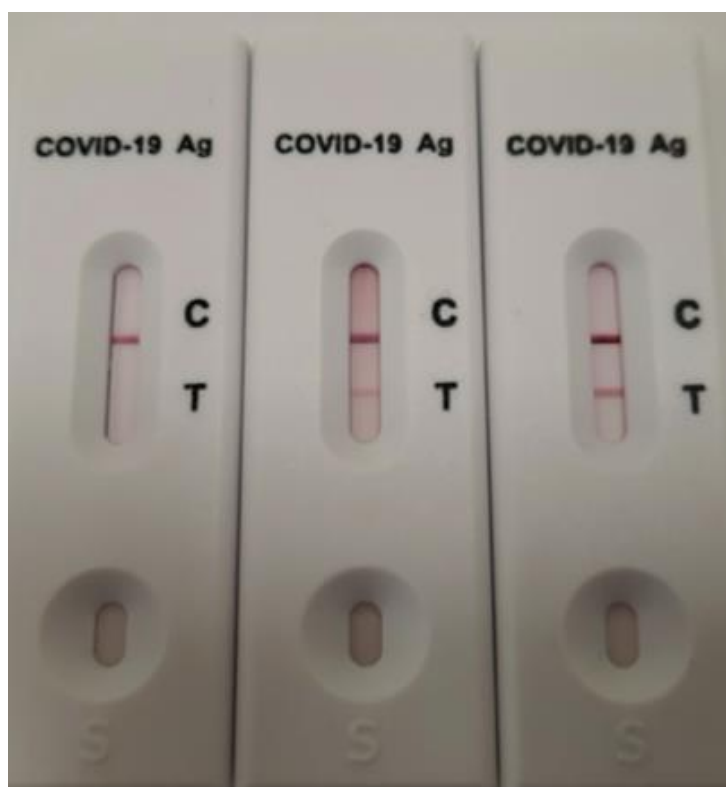
Figure 9 Illustration d'un test immunochromatographique (COVID19Speed-Antigen Test de la Société Biospeedia). Le prélèvement est déposé dans la cupule S située au bas de la figure. La ligne C correspond au contrôle de bon fonctionnement du test ; son absence est synonyme d'un test invalide. La ligne T (test) correspond à la détection de la protéine N du virus SARS-CoV-2. Le test présenté à gauche montre une réactivité négative. Le test présenté au centre indique une réactivité faiblement positive. Le test présenté à droite révèle une réactivité positive.
