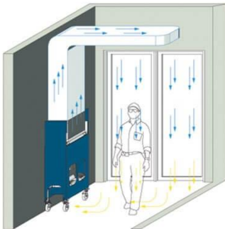
Figure 17 : La cabine de douche à air.
