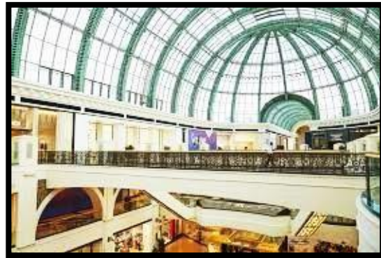
Figure 96 : l'éclairage zénithale par le dôme vitré. Source : www.slideshare.com
