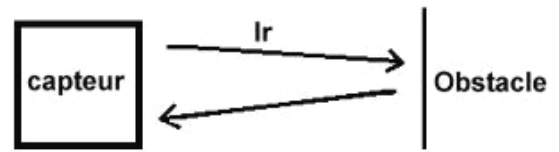
Figure 1.15.b : Principe du capteur infrarouge
