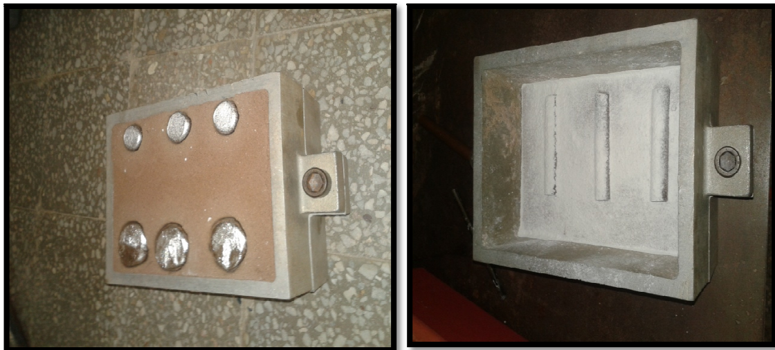
Figure IV-1: Représente les étapes de la coulée des alliages Al-si.
