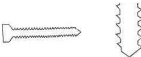
**Figure 17 : vis à os cortical**
