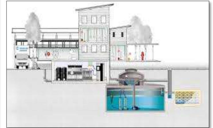
Fig101. Réservoir d'eau pluviale
