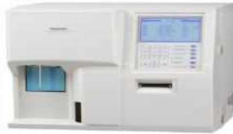
Figure 9: Représente un Coulter qui est utilisé pour la détermination de l'hémoglobine et de l'hématocrite
