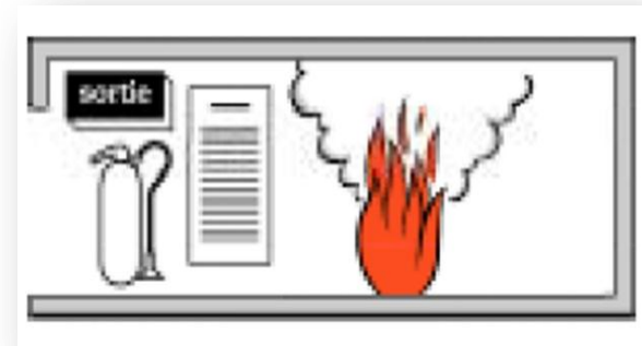
Extincteurs mobiles au niveau des dégagements
