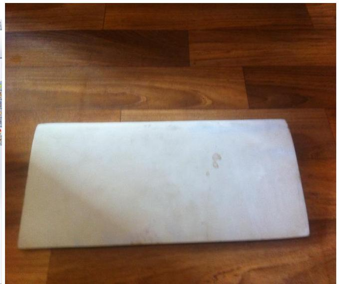
*Profil NACA 23012 réalisé.*
