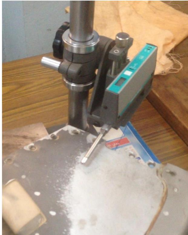
**Figure IV.12.** *Rugosimètre 2812S.* [17]
