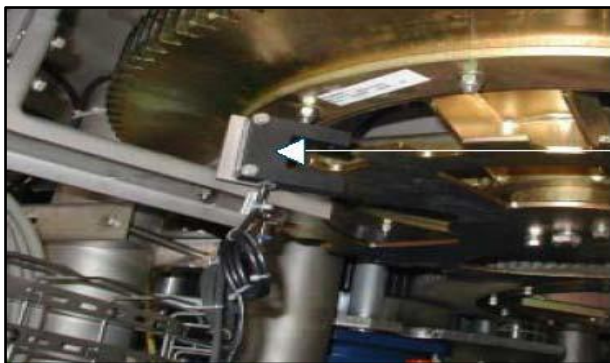
Figure II.8 : Capteur de vitesse d'horloge [5] Figure II.9 : Capteur de présence bouteille[5]
