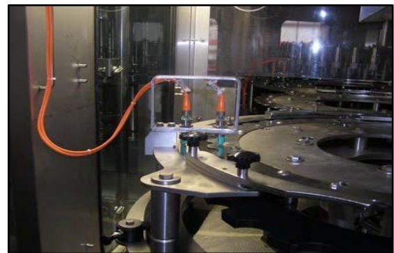
Figure II.8 : Capteur de vitesse d'horloge [5] Figure II.9 : Capteur de présence bouteille[5]
