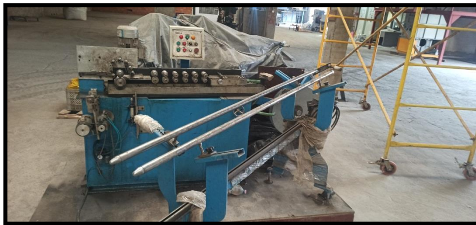
Figure 1.11: Machine de Production de Conduit d'air cylindrique en aluminium
