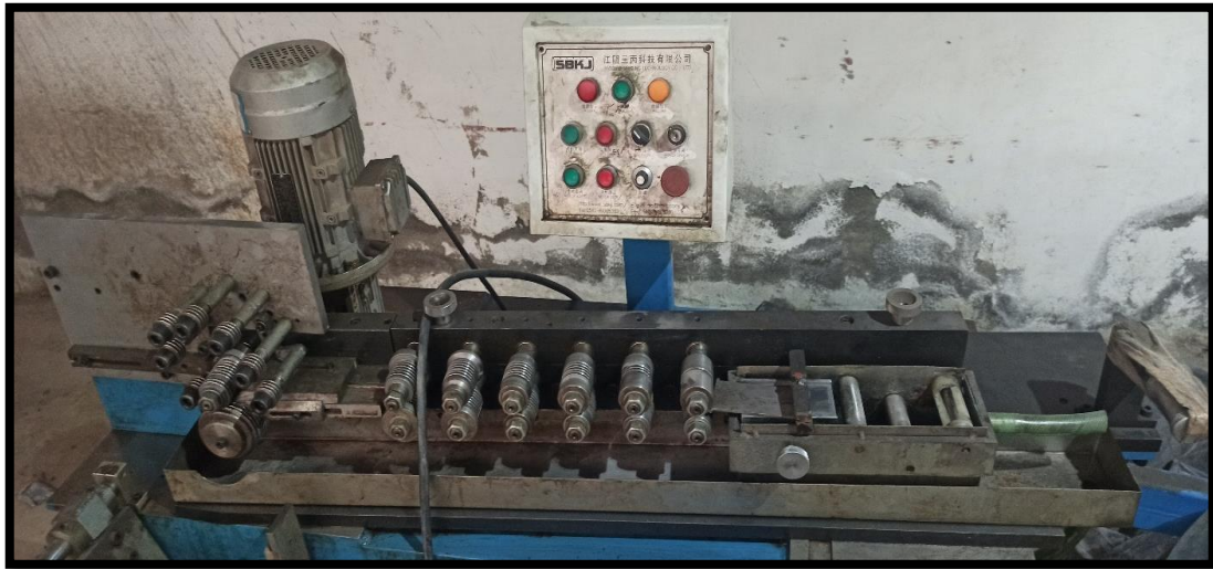
Figure 1.16: Roulettes de façonnage de la bande d'aluminium
