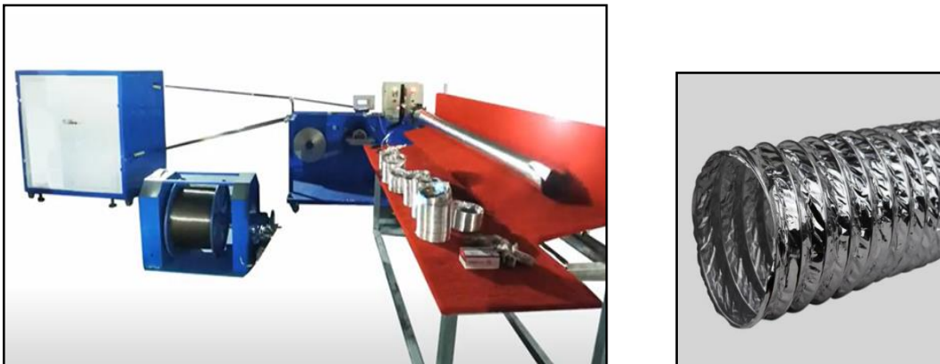
Figure 1.4: Machine de production flexible avec fil d'acier cylindrique
