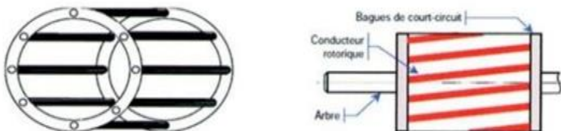
Figure 1.5: Rotor à cage (tôles magnétiques, conductrices d'encoches (barres) etanneaux (bagues) de court-circuit)
