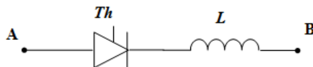
Figure. III.2 : Protection contre les di /dt.
