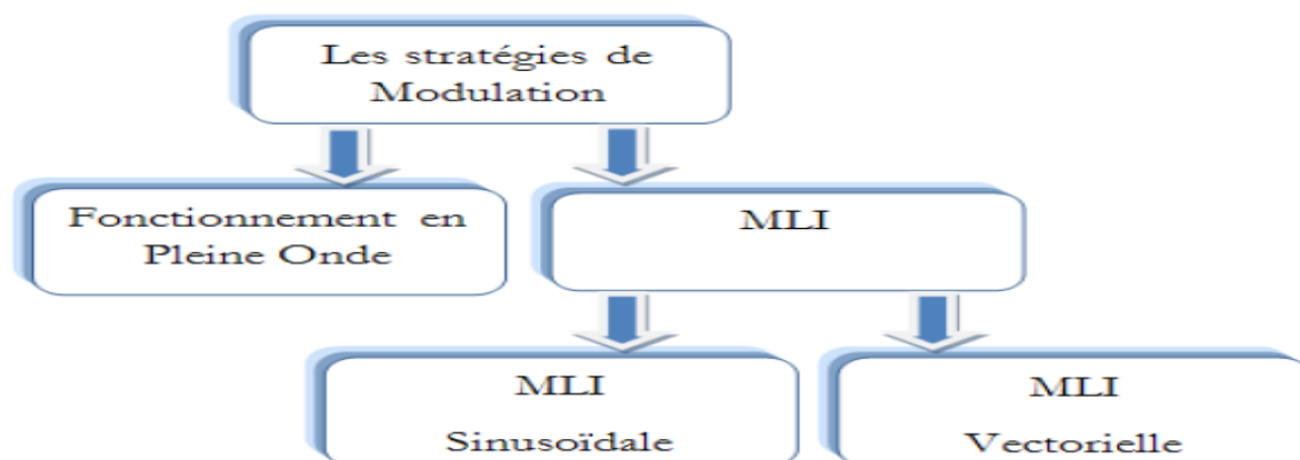
Figure II-12 : les différentes techniques de commandes.
