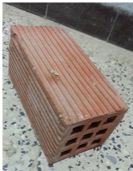
photo 12 brique de terre cuite creuse de 10x10x20
