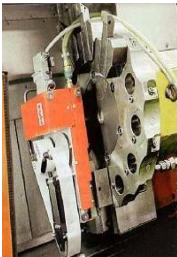
Figure 27: opération de superfinition [10].
