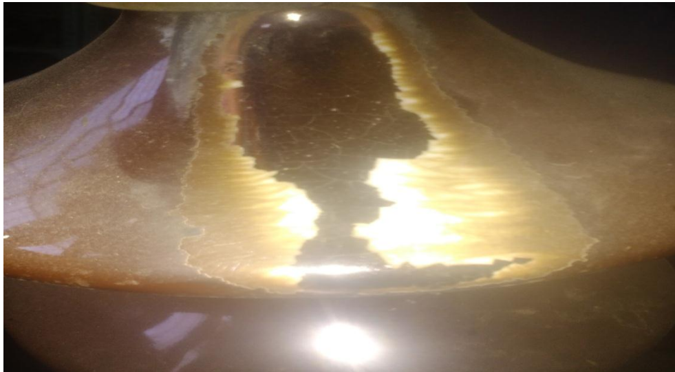
Figure 2.2 : Isolant amorcer par une décharge partielle
