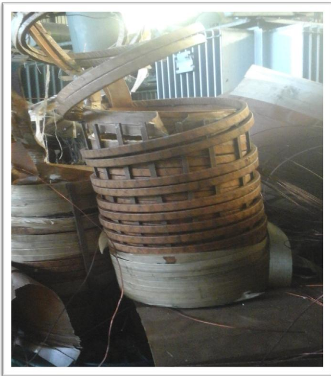
Figure 2.7 : l'enroulement BT avec Déformations géométriques des' enroulement
