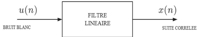
Figure 2.3: Génération d'un signal aléatoire corrélé [16].
