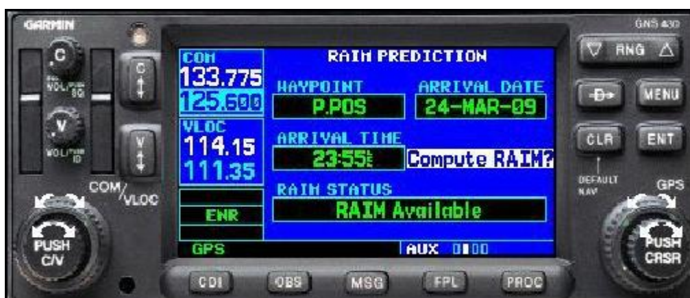
Figure (I. 3) : Indicateur RAIM embarqué
