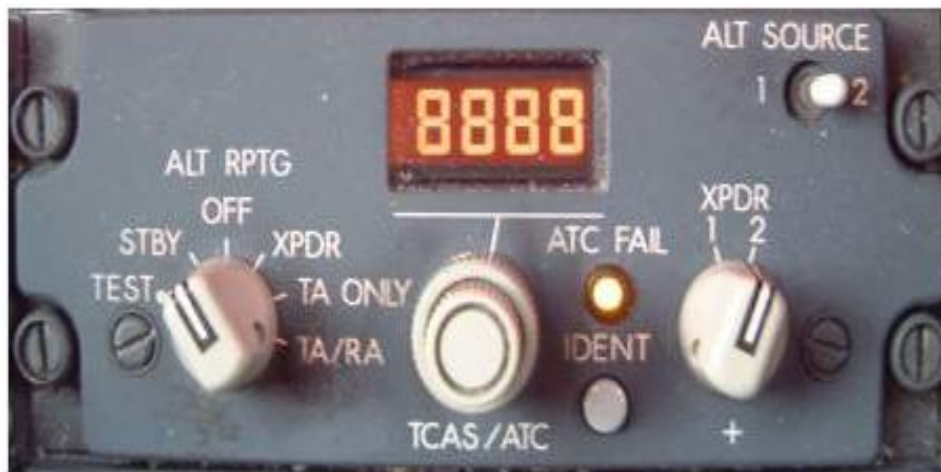
Figure III.1 : Boîtier de commande TCAS
