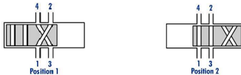
Figure1.19. Distributeur 4/2 en état de repos et travail.
