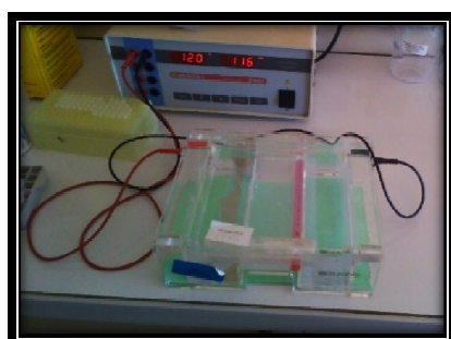
Cuve à électrophorèse branché au générateur
