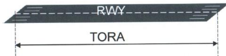
Figure II.2 : longueur utilisable pour le roulement au décollage.
