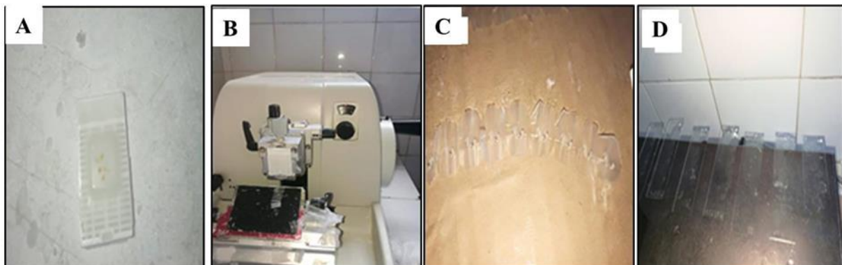
Figure 41. Étapes de coupes histologiques. A, biopsies bronchiques incluses au bloc de paraffine. B, un microtome (LEICA). C, coupes histologiques de 3 µm (ruban). D, étalement des coupes histologiques sur lames.
