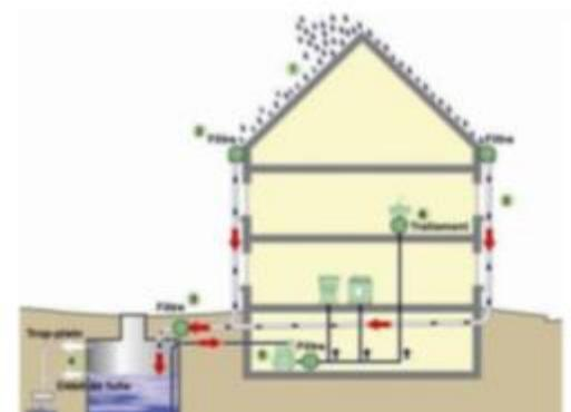
Figure 81-Schéma d'une installation – guide conseil « critères techniques pour une mise en œuvre énergétique et durable » (Source : Bruxelles Environnement)
