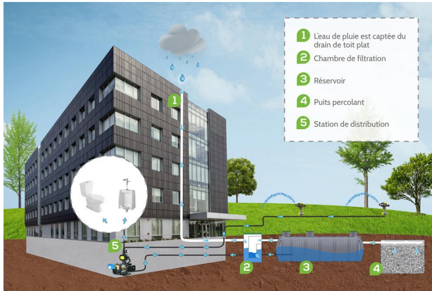
Figure 36: récupération des eaux pluviales, .source : http://econeau.com/wp-content/uploads/2016/02/schema-commercial.jpg
