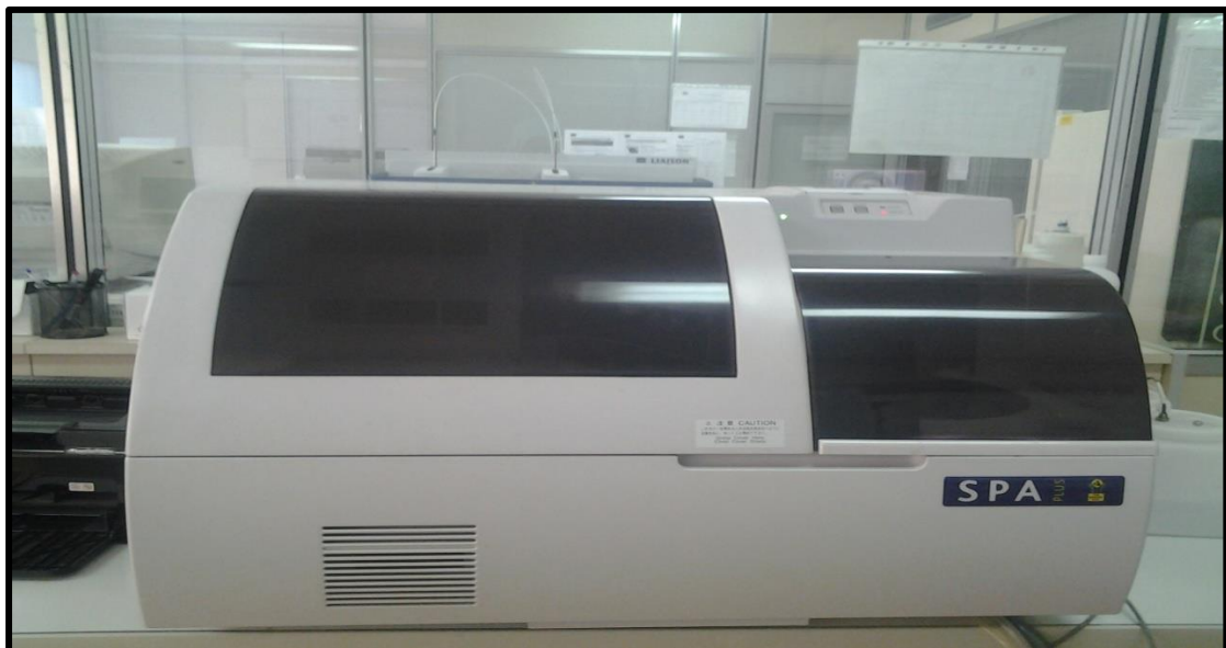
Figure 14 : l'automate turbidimètre SPAplus
