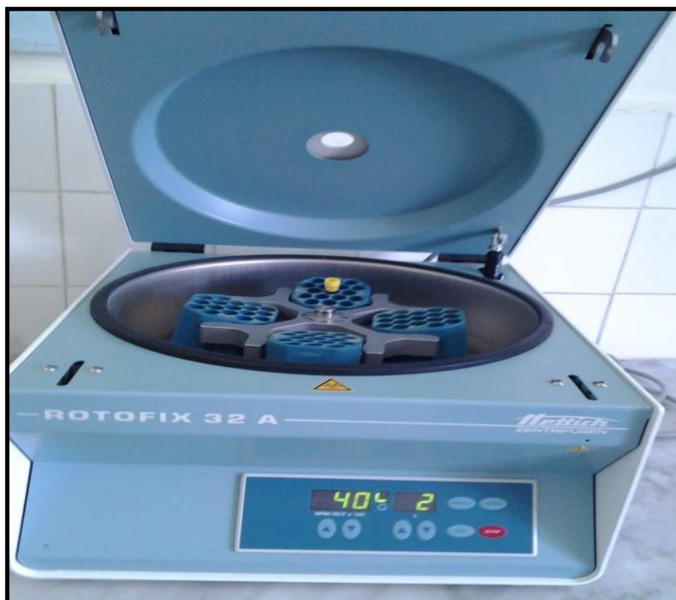
Figure 11: centrifugeuse de modèle : ROTOFIX 32 A
