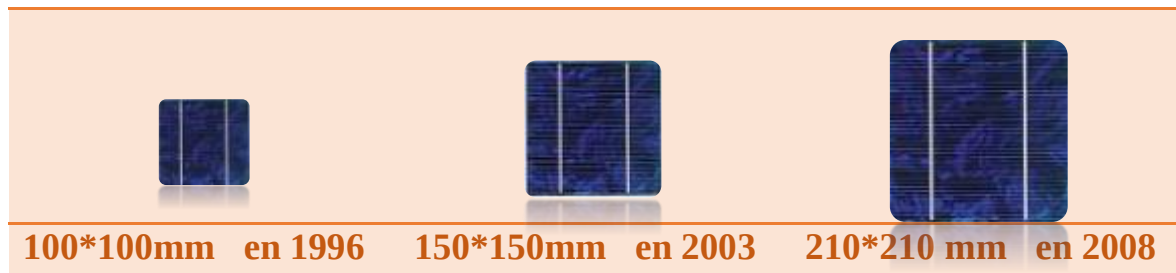
Figure 1.18 : Évolution de la taille des cellules silicium photovoltaïques ces dernières années.
