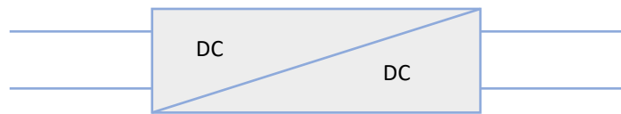
Figure 2.5: Symbole d'un convertisseur DC-DC.
