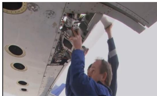
Figure 1.11 –Essai d'EMA comme actionneur de commande de vol primaire pour un aileron d'A320 (Projet de recherche) [12]
