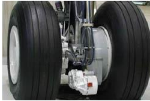
Figure 1.10 –Roue motorisée pour un roulage plus « vert » (Projet de recherche pour une industrialisation en 2016) [11]
