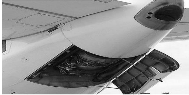
Figure 1.6 – APU en queue d'avion[2]
