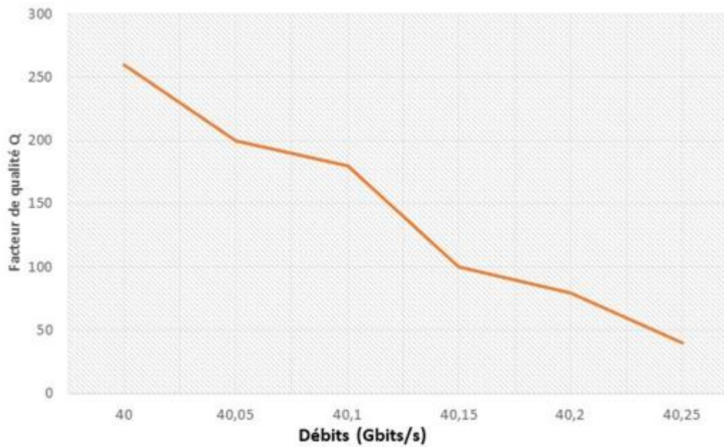
Figure 3.15 : Q en fonction du temps dans un système modulé en DPSK
