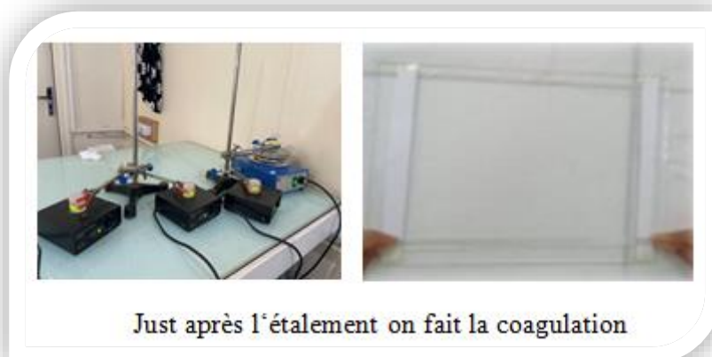
Figure 24: Représentation de la méthode préparation de membrane par la technique d'inversion de phase.
