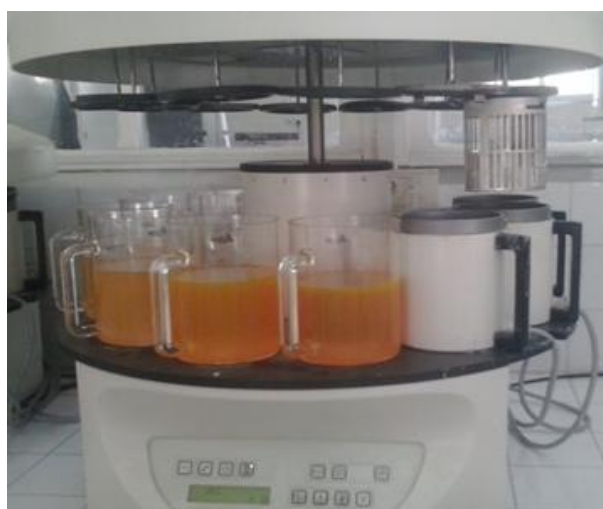
Figure 19: Circulateur automatique (LEICA TP 10 20)
