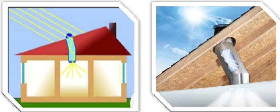
Figure 42 : Schéma d'un conduit de lumière
