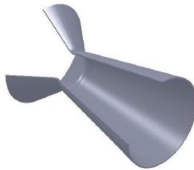
b) Convergent divergent nozzle (de Laval)
