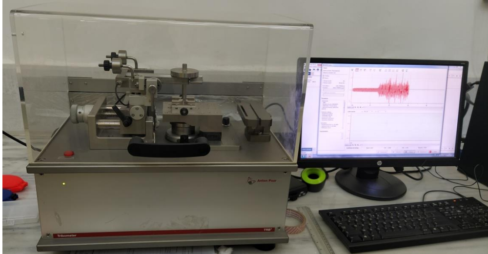
Figure 3. 31 Tribomètre de type CSM, Suisse, Anton Paar TRB3.
