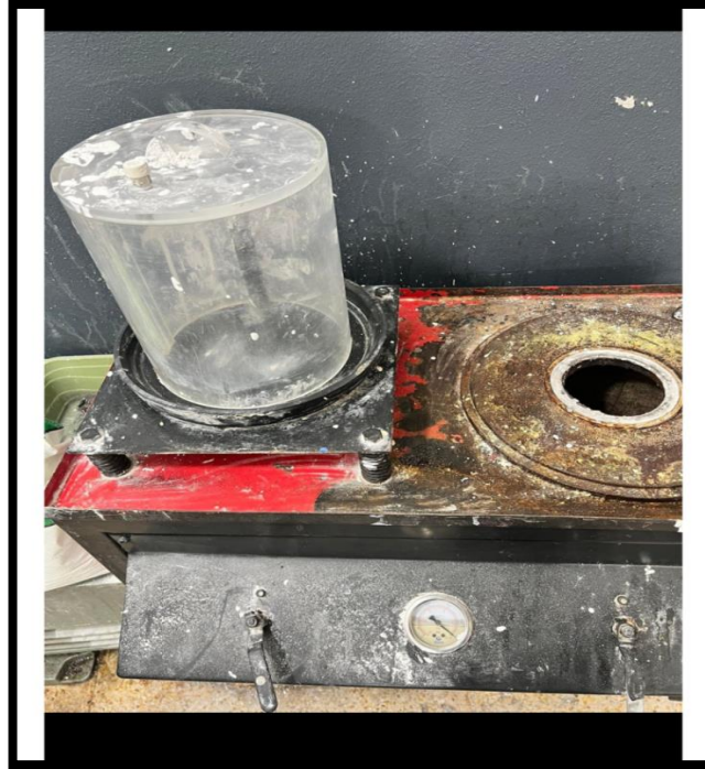
Figure 3. 11 Machine de dégazage
