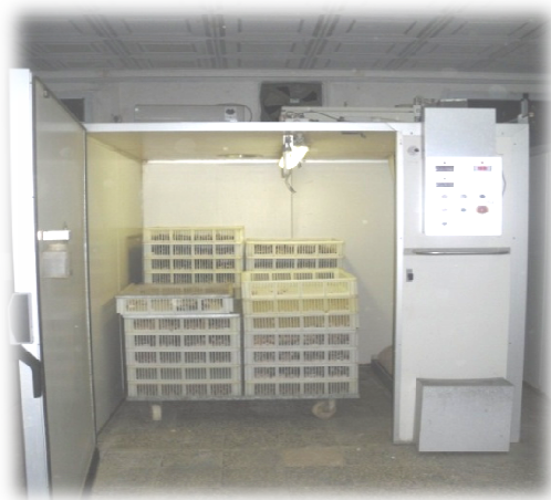
Figure 11 – Eclosoir type Victoria I-72 au niveau de couvoir de CCZ (Originale, 2015).
