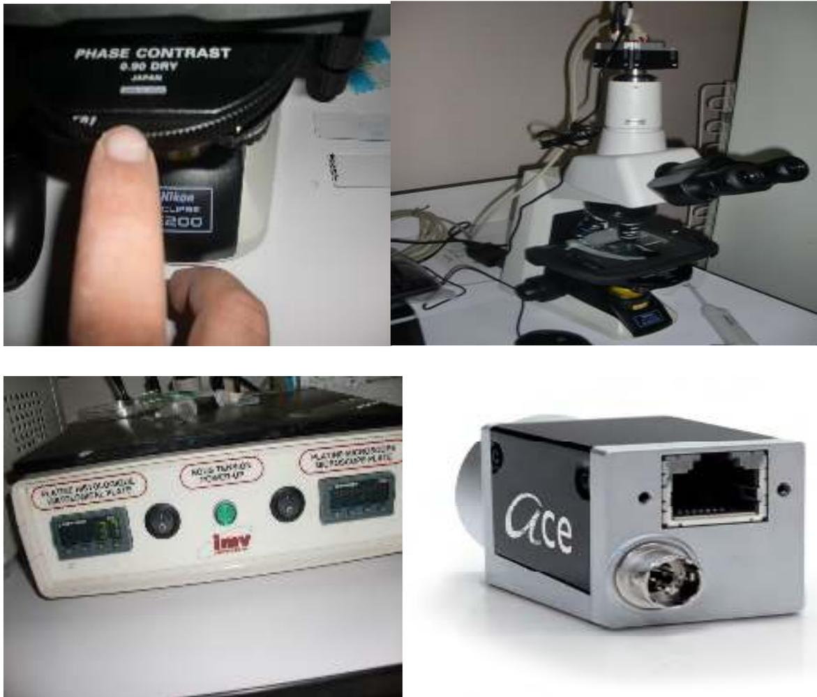
**Figure 16 :** Constituants de l'analyseur SCA (microscope -1.2-, platine -3-, caméra -4-)
