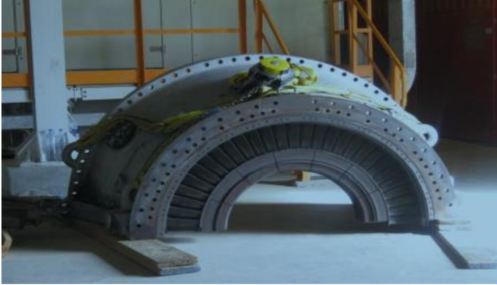
Figure 1.16. Le stator de la turbine à gaz –MS5001 PA.
