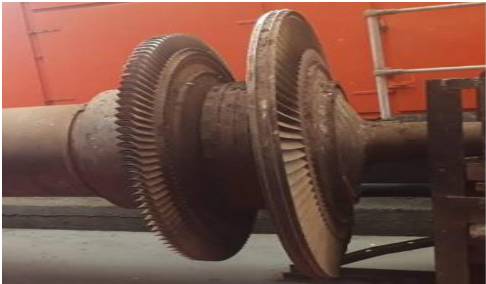
Figure 1.15. Le rotor de la turbine à gaz –MS5001 PA.
