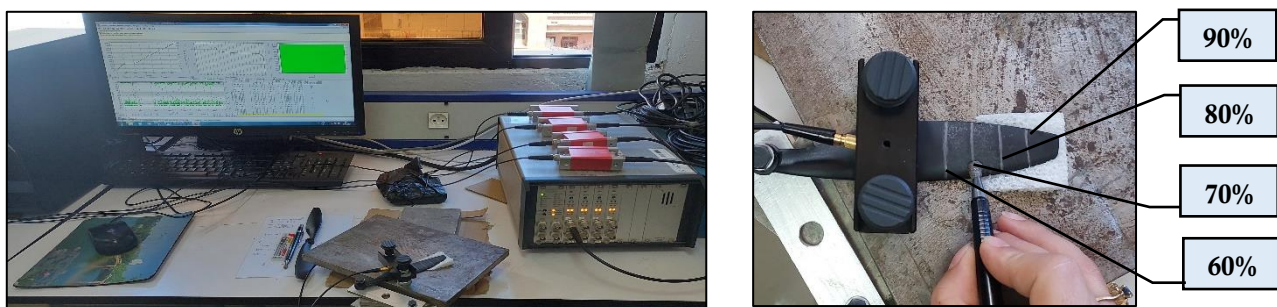
Figure V.21 : Photo réelle de l'expérience sur la demi-hélice à l'aide d'un seul capteur.
