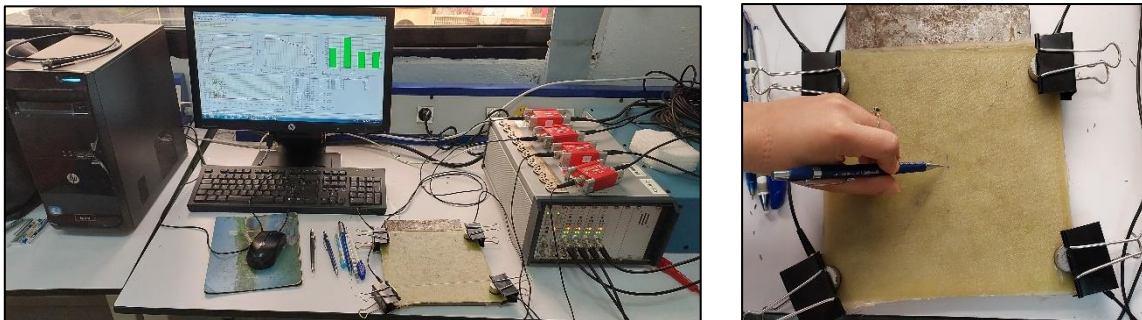
Figure V.5 : Photo réelle de l'expérience réalisée sur le CFV avec quatre capteurs.
