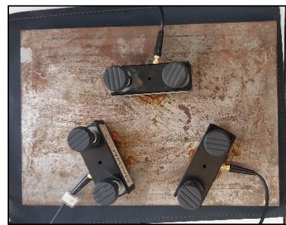
Figure V.9 : Photo réelle de l'expérience sur une PM à l'aide de trois capteurs.
