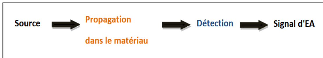
Figure II.4 : Représentation simplifiée des étapes de CND par EA.
