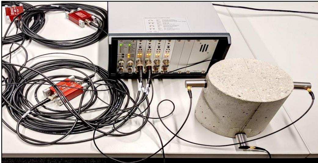
Figure III.1 : Test du CND à base EA.
