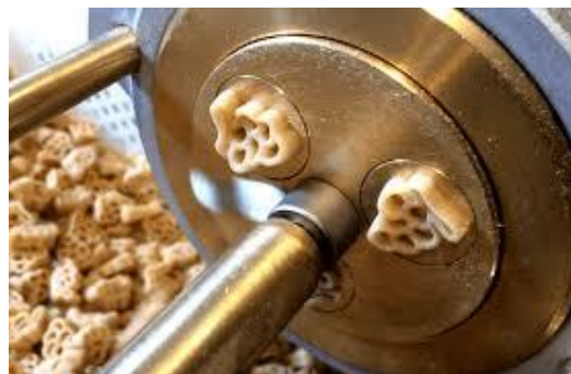
Figure (I – 3) : Extrusion agro-alimentaire.
