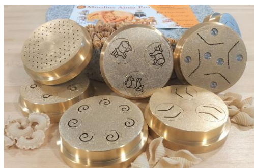
Figure (I - 9) : Les matrices de formage.
