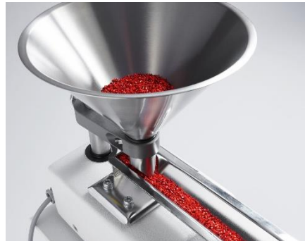
Figure (I – 7) : Une trémie.
