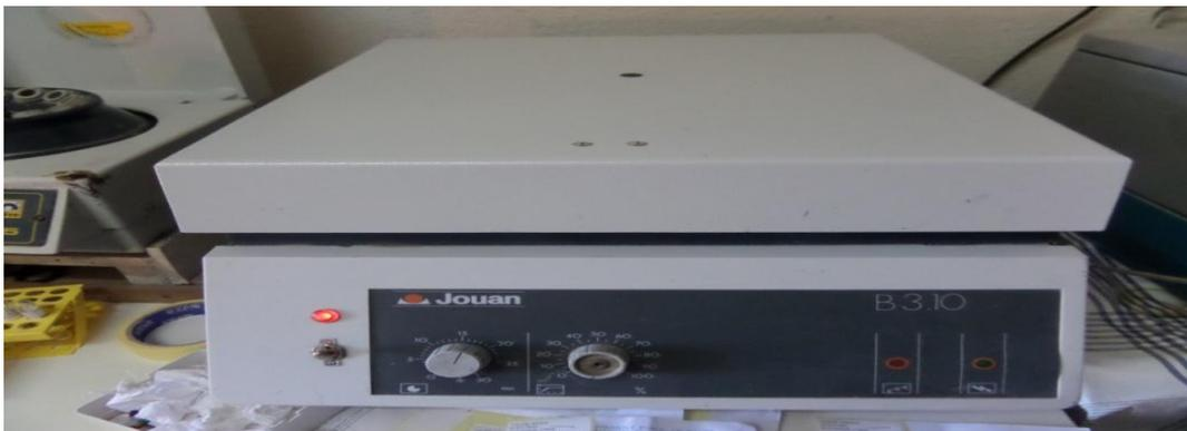
Figure 19 : Une Centrifugeuse
