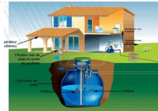
Figure80 : montre la récupération de l'eau pluviale 1
