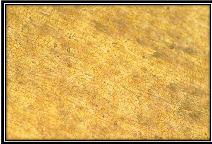
Figure 17 : échantillon traité avec alodine 1200
