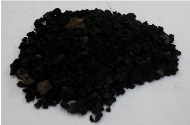
Figure II.11 ciment utilisée pour la cémentation.
