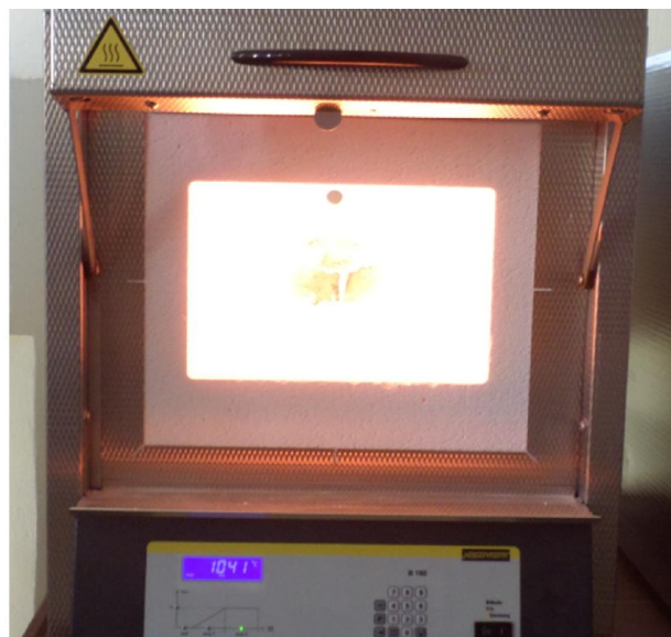
Figure II.15 Four après 8h de traitement de cémentation.
