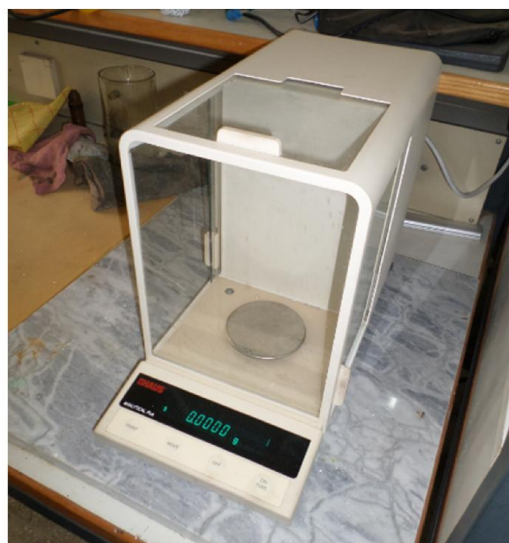
Figure II.34 Balance de précision utilisée dans le test d'usure.
