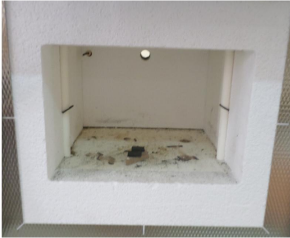
Figure II.22 pièces au cours de traitement de revenu.
