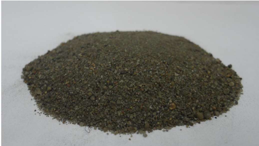
Figure II.6 La poudre de bore-azote solide utilisée pour la nitruration.
