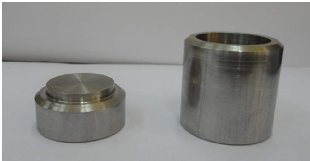
Figure II.3 Le creuset utilisé pour les traitements thermochimiques.
