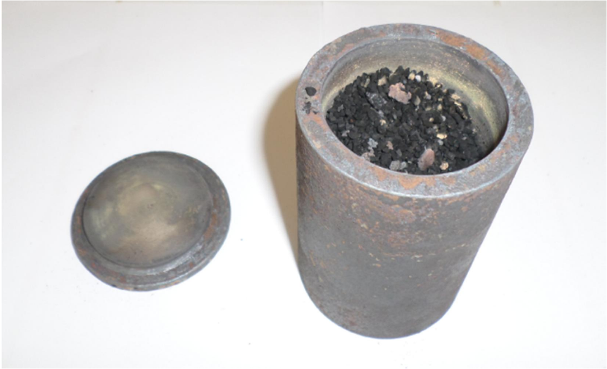
Figure II.16 creuset ouverte après le traitement de cémentation.
