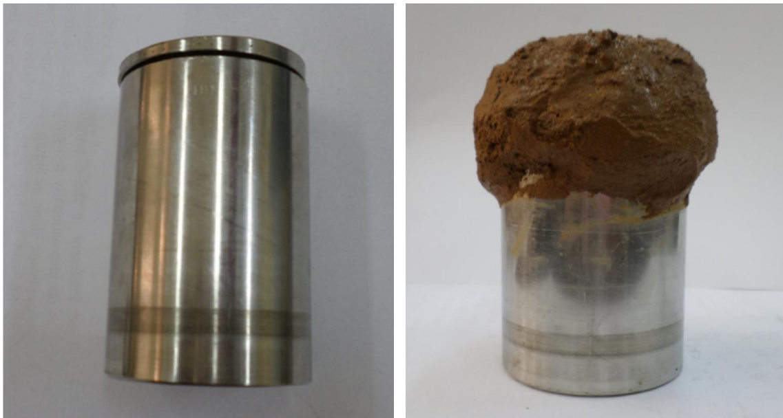
Figure II.12 creuset avec une couche d'argile avant de traitement de la cémentation.
