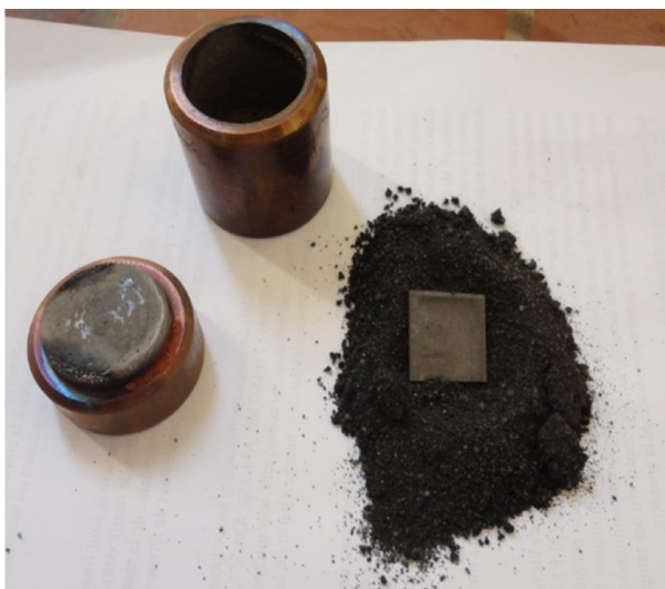
Figure II.09 creuset ouverte après le traitement de nitruration.
