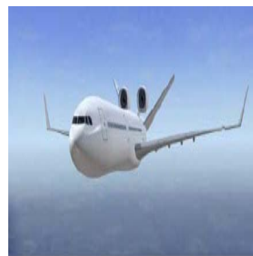
- b - Moteurs au-dessus du fuselage
