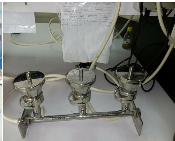
Photo 15 : Rampe de filtration
