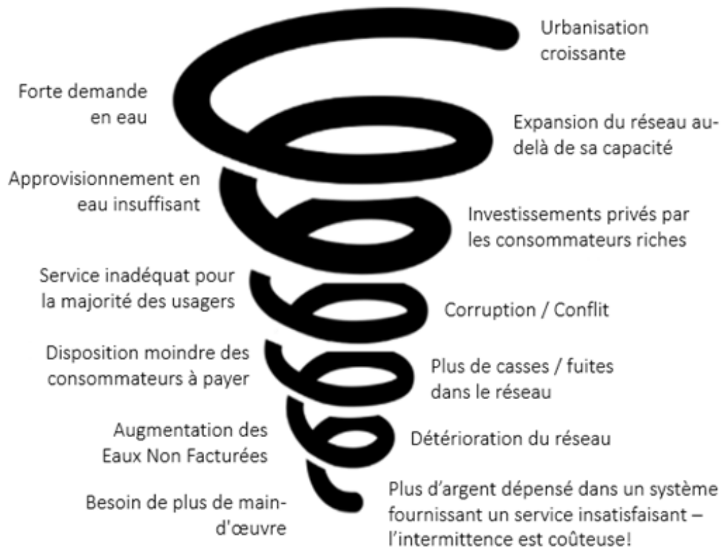
Figure 16 : Spirale de dégradation du service de la distribution d'eau en intermittence
