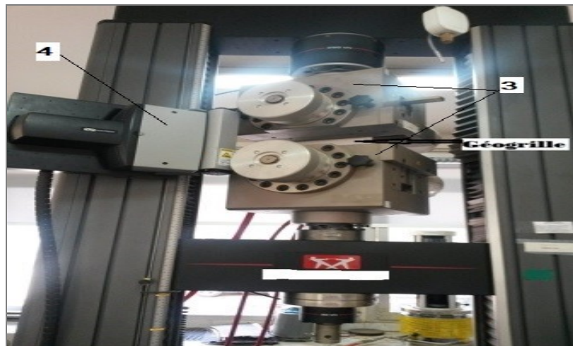
Figure. IV.2- Banc de traction INSTRON 5900 pour résistance à la traction [67].
