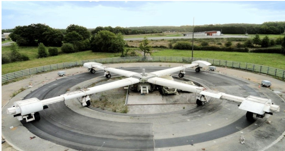
Fig. III.14- Manège de fatigue de l'IFSTTAR
