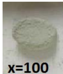
Figure 3.7. Une pastille de STO après la mise en forme.
