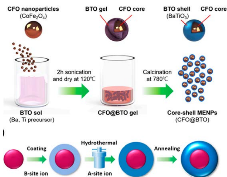
Figure 1.19 : Préparation du CoFe 2 O 4 @BaTiO 3 en utilisant la méthode sol gel hydrothermale [33].
