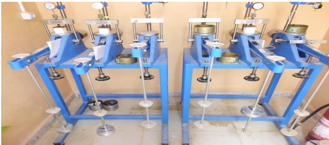
Figure IV.12 : Appareillage Oedométrique pour les essais de fluage
