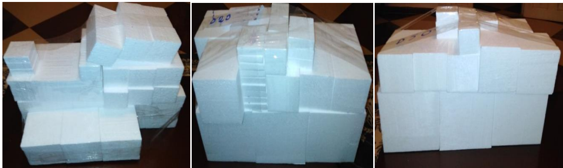
IV.3 (a), (b) et (c) : Préparation des éprouvettes pour les essais à différentes masses volumiques.
