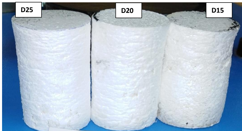
Figure V.14 : Etat d'écrasement des éprouvettes sous compression triaxial
