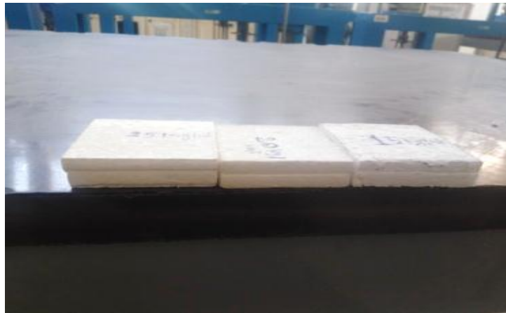
Figure V.20 : Etats des échantillons après cisaillement directe de mono-bloc EPS
