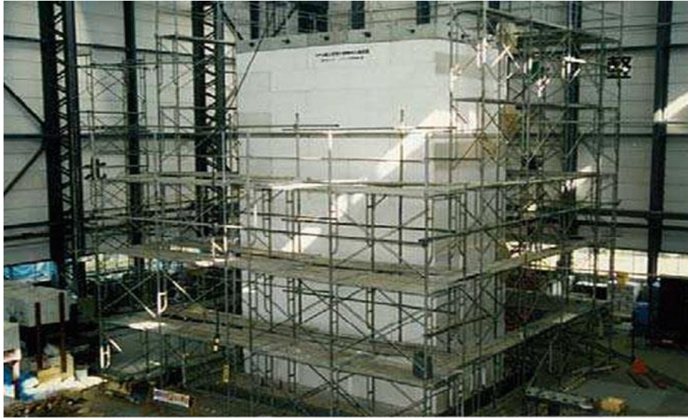
Figure I.7 : Chargement sismique à grande échelle sur table vibrante (EDO, Japon) [52]
