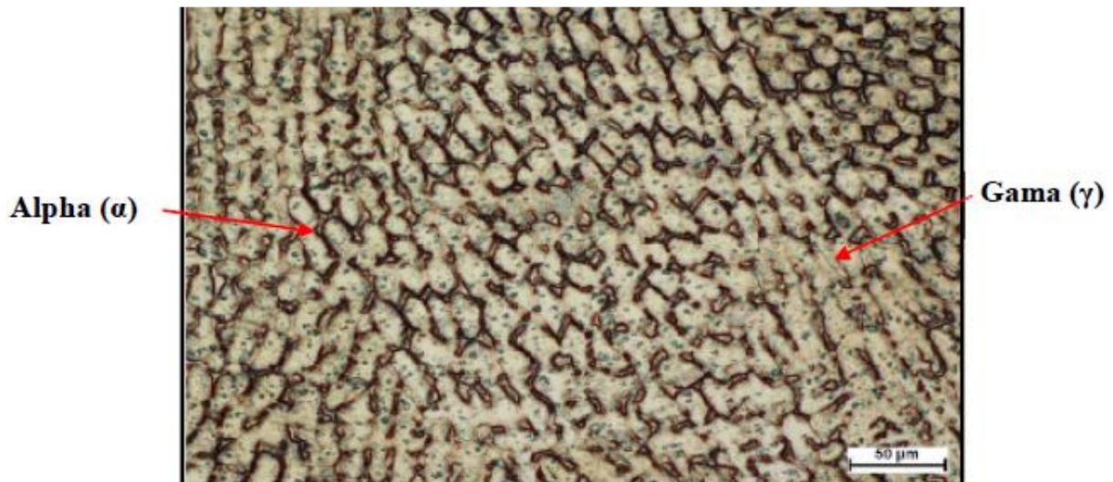
Figure IV-10 Microstructure de la zone fondue (X200).
