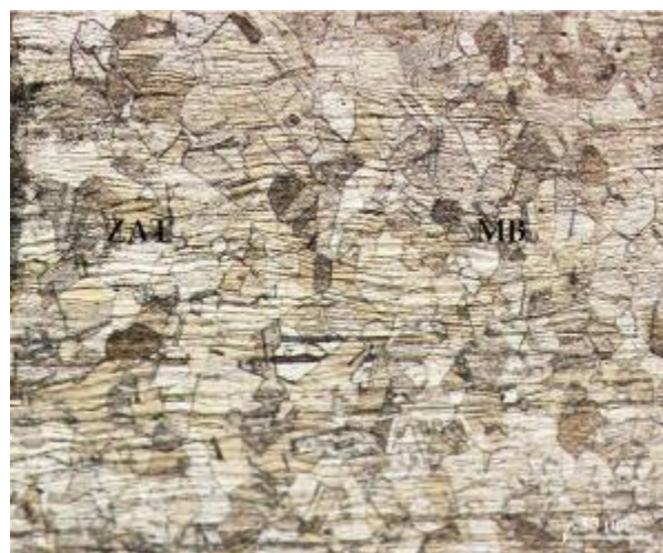
Figure IV-13 : Microstructure de la ZAT coté AISI 316L soudure ( DSS/SS)-.G200
