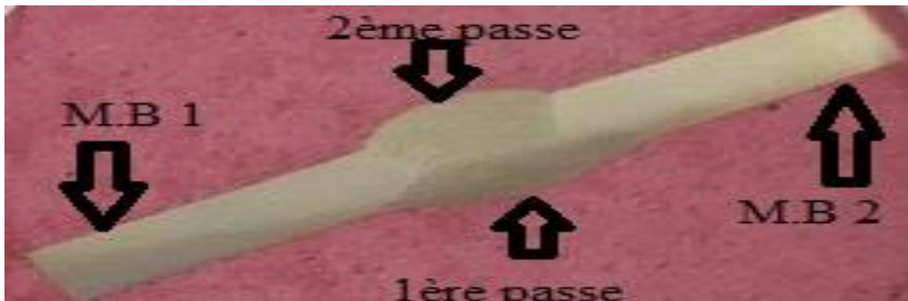
Figure IV.2 Macrographie de la soudure 316L/2205
