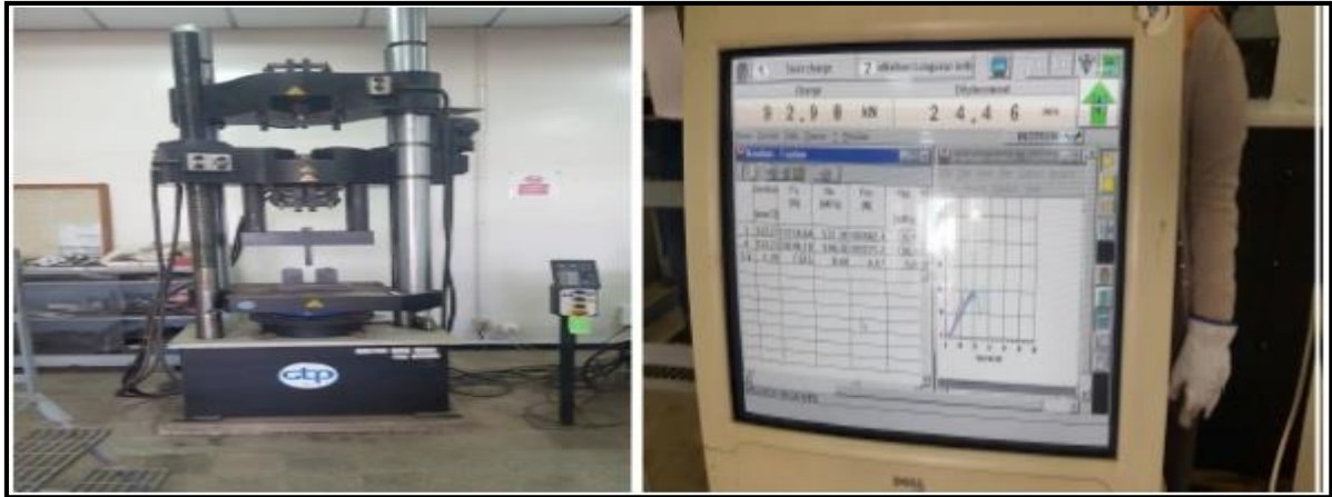
Figure III.9 : Machine de Traction (INSTRON WALPERT) pilotée par ordinateur (Soc.GTP)
