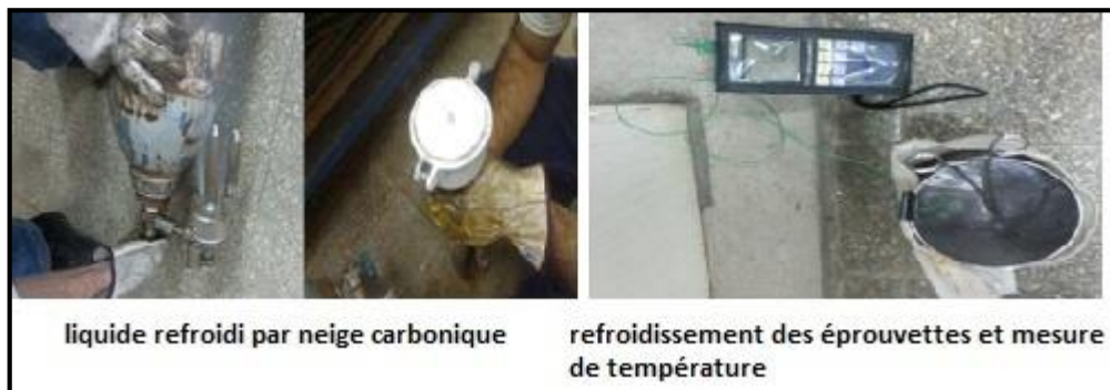
Figure III.12 : Système de refroidissement des éprouvettes Charpy V ( Soc.GTP)
