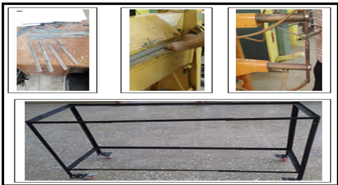
Figure 4.22 : les étapes de réalisation du support.
