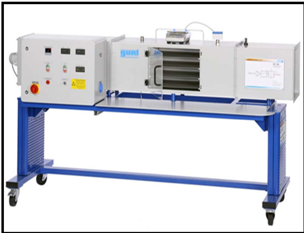
Figure 4.3 : Sécheur à convection pour des expériences de séchage sur des solides granulaires. [1]
